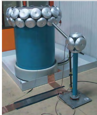
Испытательное оснащение AV до 150 кВ/75 kVA
